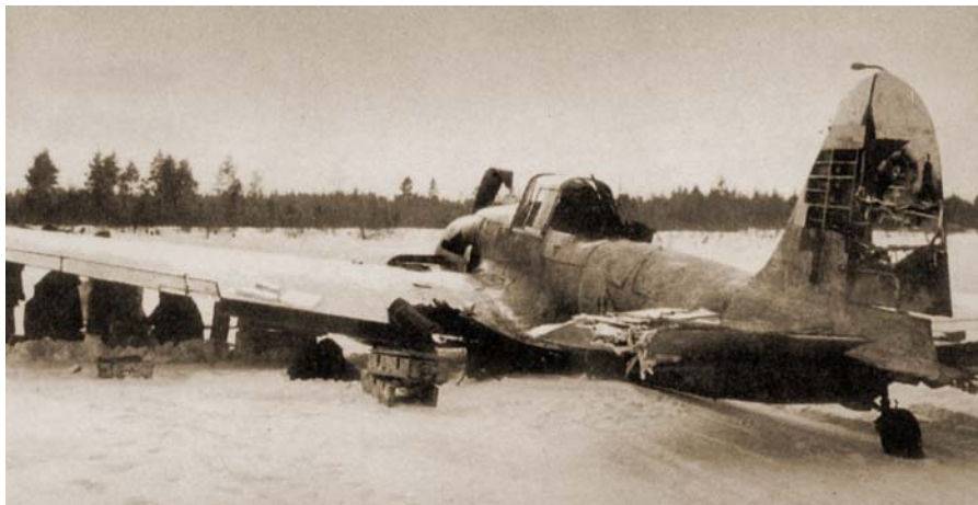
Сильно поврежденный штурмовик Ил-2, сумевший дотянуть до своего аэродрома и севший «на брюхо».
