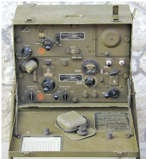
Ленд-лизовская радиостанция SCR-284, которую использовали авианаводчики на переднем крае.
